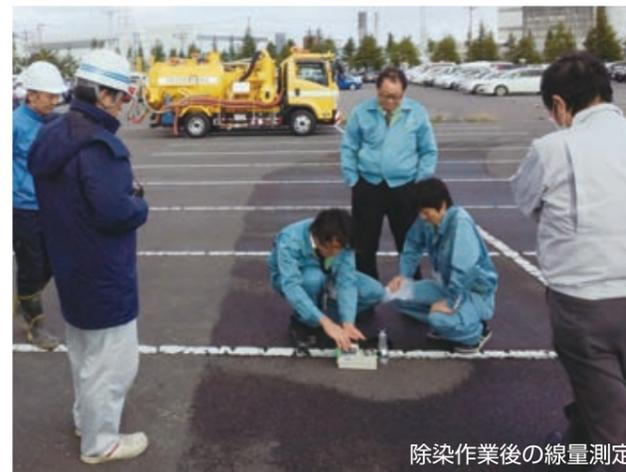
除染作業後の線量測定
