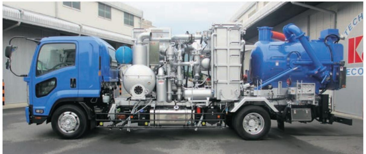
本車両は乾湿切換超強力吸引・圧送作業車です。
