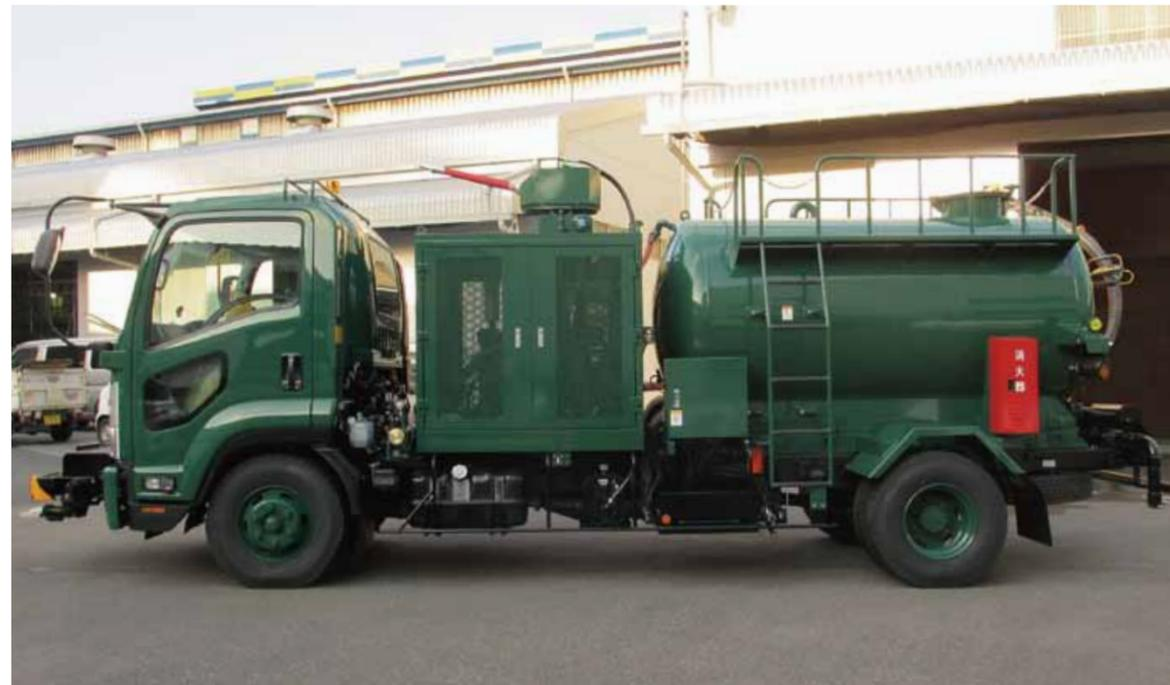
工場内の路面の清掃等を行う放水・散水車（構内専用車）です。コークスの飛散防止のため、放水銃にて湿潤させることが可能です。今回、放水銃及び散水ノズルをK&Eにて製作しており、使い勝手の良い機械となっております。
