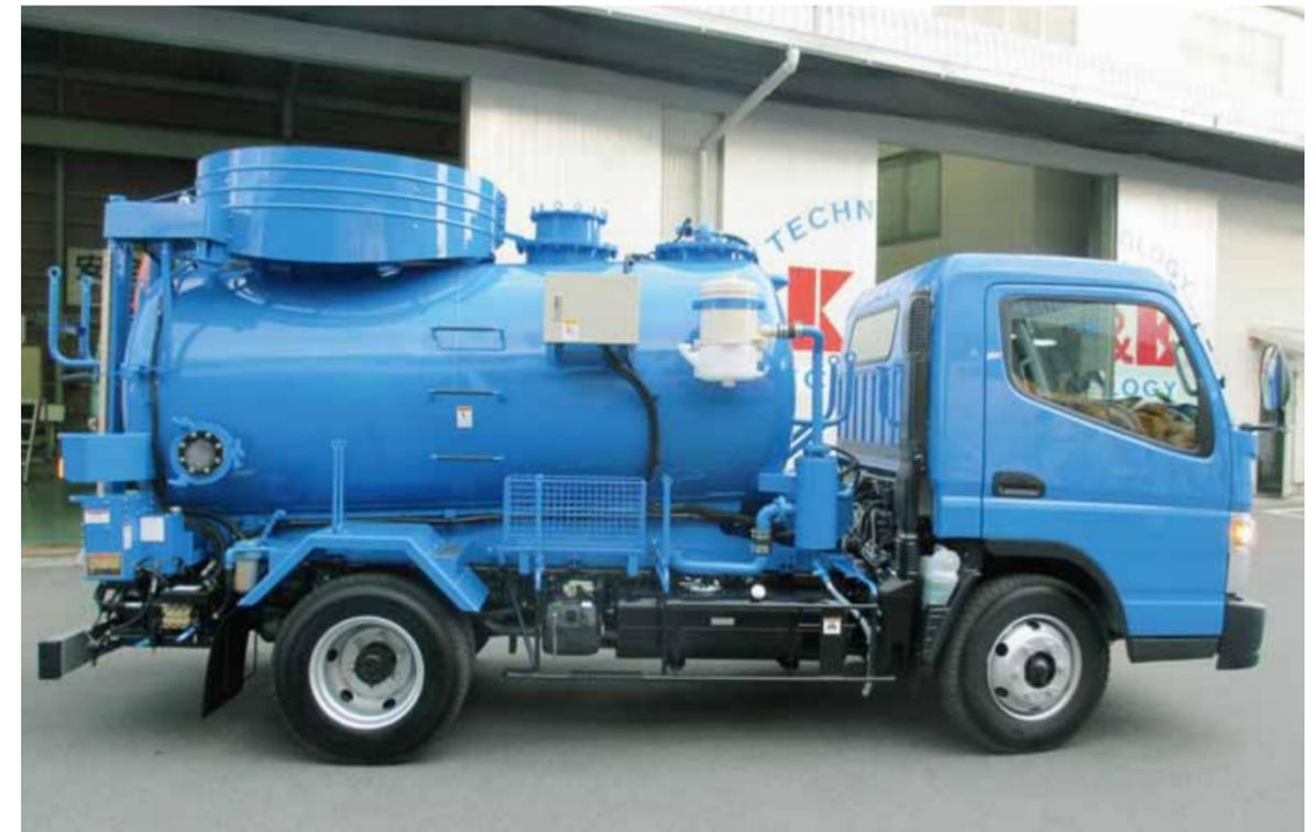
浄化槽等の清掃を行う車輛です。高圧洗浄装置を搭載しており、ひとつ上のサービスを提供できます。また、3トン車としては最大級のタンク容量を実現。2槽式タンクの前方が水タンクとなっており、簡単なバルブ操作で洗浄水を圧送することも可能です。
