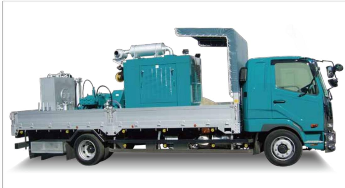
「ガン打ち洗浄作業のため、1台のポンプから70MPaで2本取りをしたい」との要望からスギノ製の本機ポンプを採用した超高压洗浄車です。水タンクへの給水ラインに濾布ストレーナーと磁石付大型ストレーナーを取り付け、異物の除去を可能としました。また、荷台をステンレス貼り、あおりをアルミ製とし、錆対策も万全。荷台前方に設置した屋根の下には棚スペースを確保する等道具保管も良好で、作業性も向上しております。
