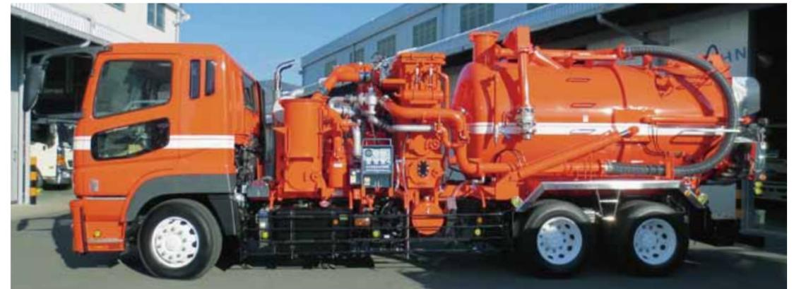
セメント会社で使用する構内専用車です。2次キャッチャー・バグフィルタ・カートリッジフィルタの3段構成で粉体を回収でき、ブロワ内でのセメント固着を防ぐ為空冷ブロワを採用しました。また、乾湿切替でありながら、粉体吸引管と満量装置を前方に取り付けることで液体吸引でも従来と同様に作業可能です。
