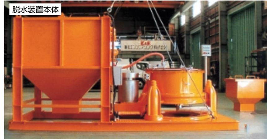
生コンプラントの稼働時に生じる残コンや洗浄汚水を、有孔バスケット方式の遠心分離機に濾布を装着し、高精度に固液分離する脱水装置で、汚泥の減容化、及び濾過水の再利用が可能になりました。
