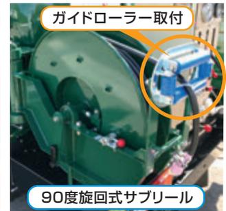
構内での洗浄作業用として、メインリールをなくし、サブリールを2基搭載し、同時に2つの洗浄ガンが使用可能な2トン車架装の高圧洗浄車です。
