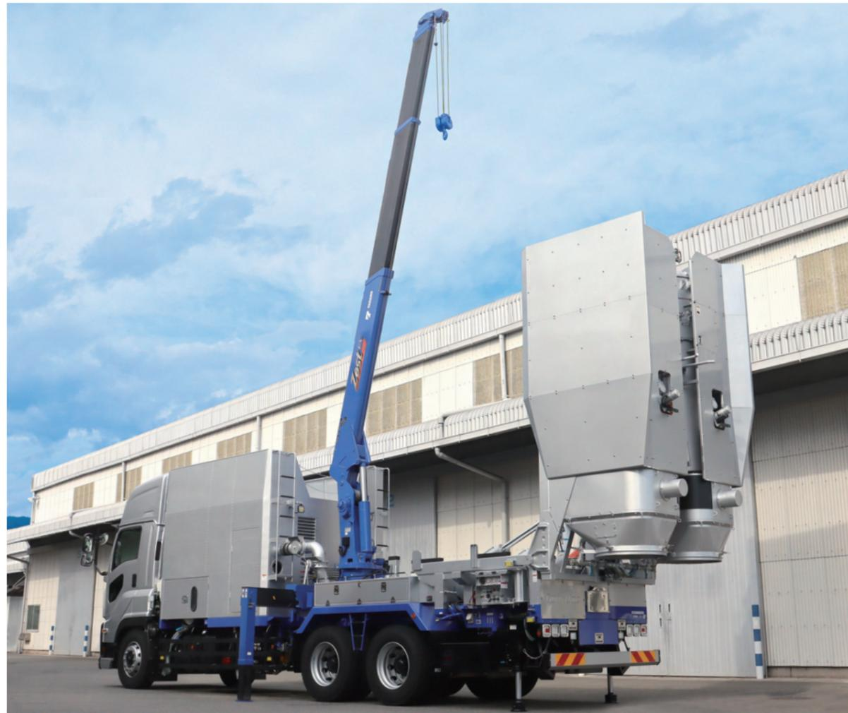
粉粒体を周囲に飛散させることなく、**ほぼ100%の回収率**を実現した超強力吸引作業車です。吸引ホースをセットすれば、1台で**吸引から袋詰めまで対応**できます。また、袋詰めした回収物の荷役作業をその場で行うため、クレーンを搭載しました。
