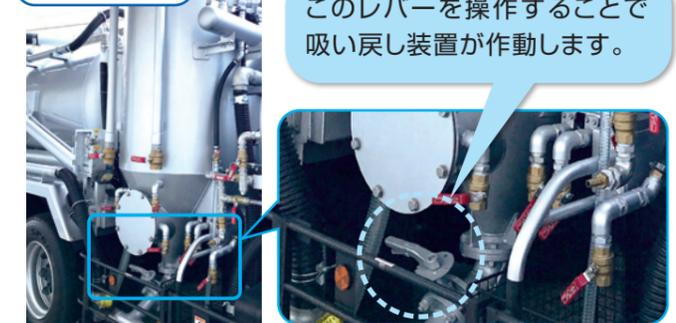
このレバーを操作することで吸い戻し装置が作動します。
