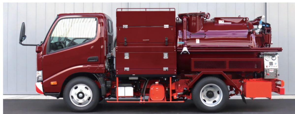
中型車では入れない、都市部のオフィス・住宅街など狭い場所での作業に特化した、小回りの利く2トン車架装の高圧洗浄車です。
