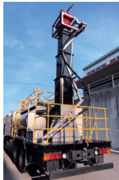
伸縮タワー 7m上昇時
