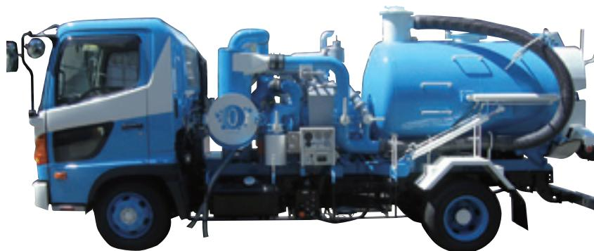
ブLOWER循環水が不要で、メンテナンスが楽な乾式吸引作業車ネオモバイルの改良型を製作しました。
