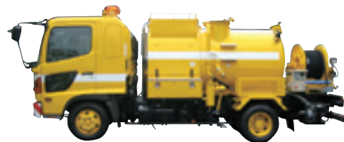
高圧洗浄車(後方リール) (JS-04W2320)
