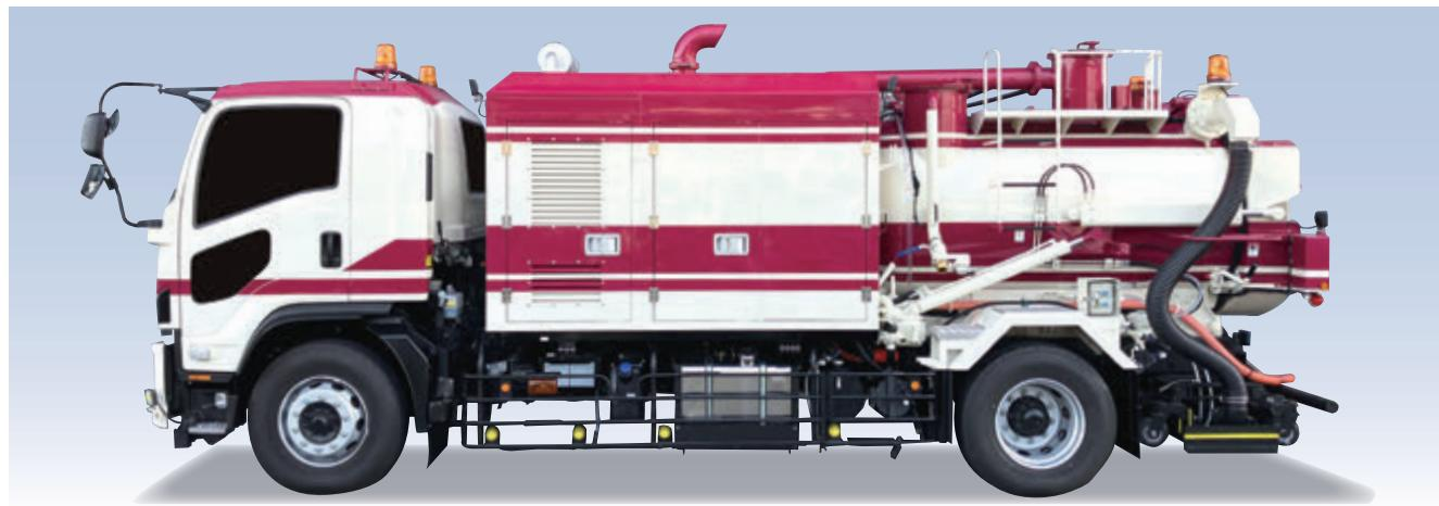
本製品は、走行(低速)しながら路面の洗浄・吸引を行うことが可能な、洗浄吸引型路面清掃車です。車両後方に設けた洗浄吸引アタッチメントで路面に高圧水を噴射し、粉じんを浮かして吸引回収します。これらはアタッチメントの枠内で行う為、清掃作業に伴う発じんがありません。また、清掃後の路面は適度に湿り(打ち水効果)、清掃後の発じんも抑えられます。
