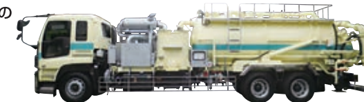
粉粒体吸引圧送車(NSR-16BWYT) ※空冷式ブロワ搭載車
