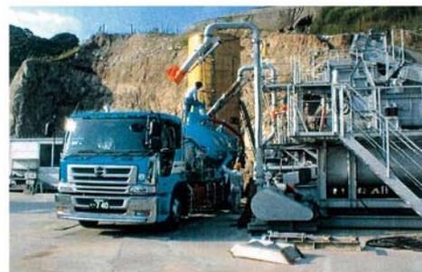
流動化処理土製造プラントで製品を作り車輻に投入します。
