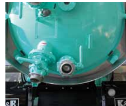
ハッチ下部排水口・中央最下部
