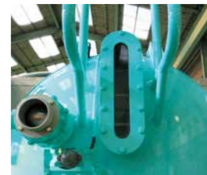
ハッチレベルゲージ、上部排水管
