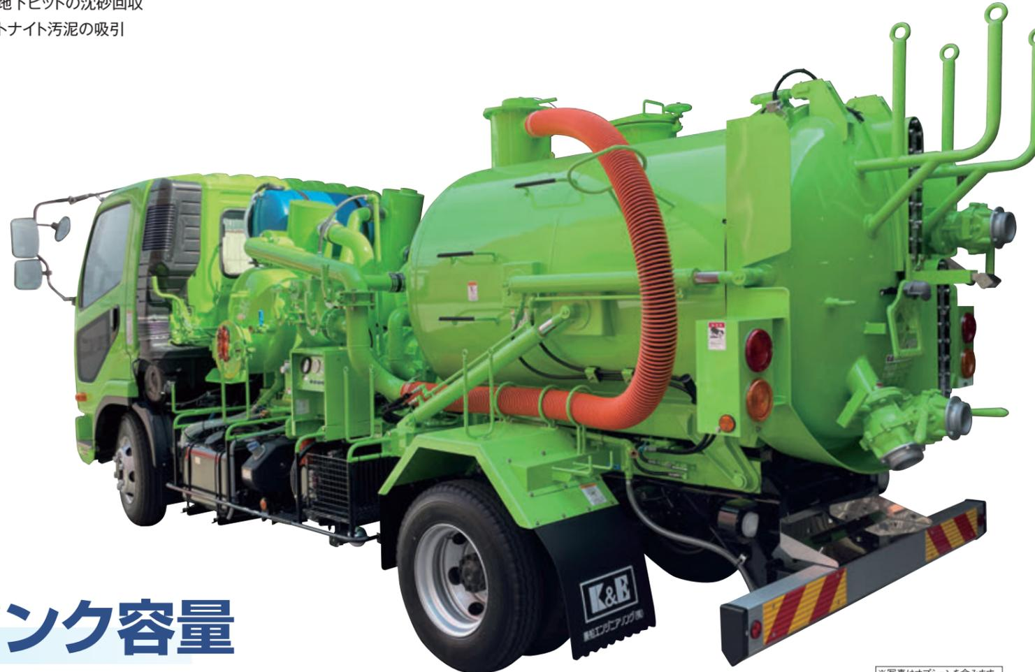
心臓部には低騒音湿式V型エンドレスブロワを搭載しております。ブロワの冷却装置にはSHAC (Self-help Air Conditioner) を採用し、連続運転における高真空維持時間が長くなりました。また、ブロワ本体は分割型とし、冷却装置も大気利用型であるため、メンテナンス性が向上しました。(一部の機種は除きます。)
