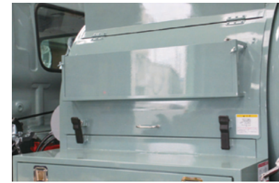
機械室カバー看板差し
