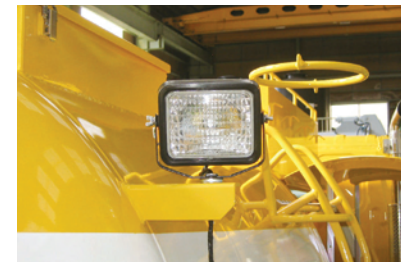
水タンク後方上部作業灯
