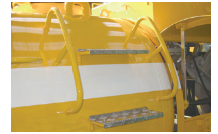
タンク昇降用手すり
