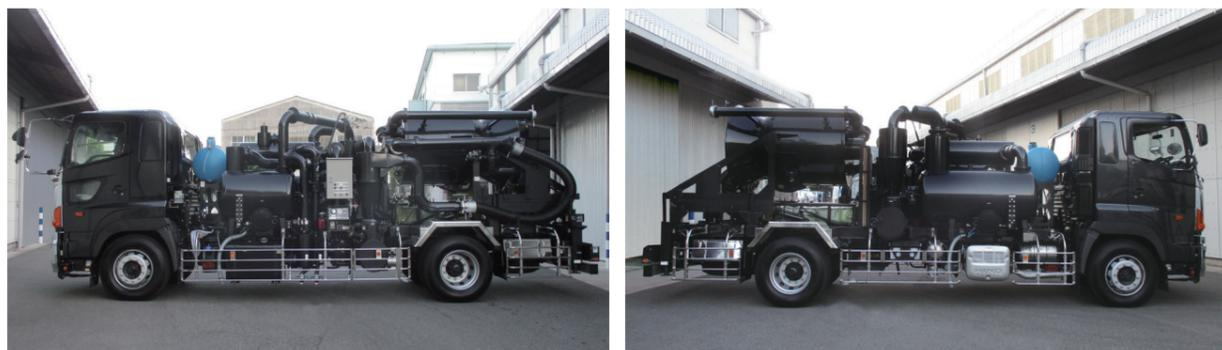
本車両は浄水設備等で使用する濾材の回収用超強力吸引作業車です。
