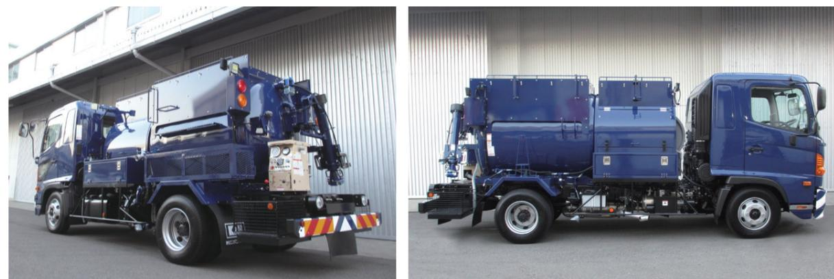
本車両は、「自動回転数制御機構」を採用した高圧洗浄車です。
