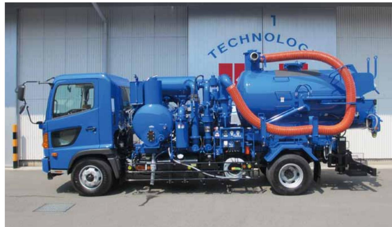
4トンクラスのホイールベースへ50m<sup>3</sup>/minのプロワを架装しました。レシーバータンクがリフトアップ機構付きであり、ダンプ等への直接投入も可能な構造となっております。
