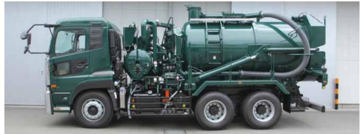
風量40m<sup>3</sup>/minのスーパーモービルをショートホイールベース車に(WB=4,500mm)架装しました。2デフ・20トンでありながらコンパクトな車両です。小回りが利き狭い場所での作業を可能にしました。また、本車両には高圧洗浄装置、2次キャッチャーをオプションで装着しております。
