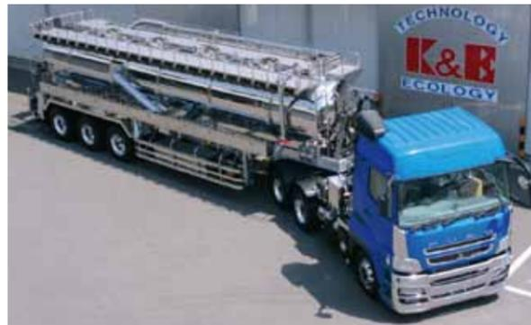
トラック側に吸引装置を架装し、トレーラー側にレシーバータンクを架装して、連結させて作業を行う強力吸引作業車です。トレーラータイプへの架装としては最大の風量40m<sup>3</sup>/minを実現させました。22m<sup>3</sup>ものタンク容量と20トンの積載量が特徴で、一度に大量の吸引物を輸送することができます。
