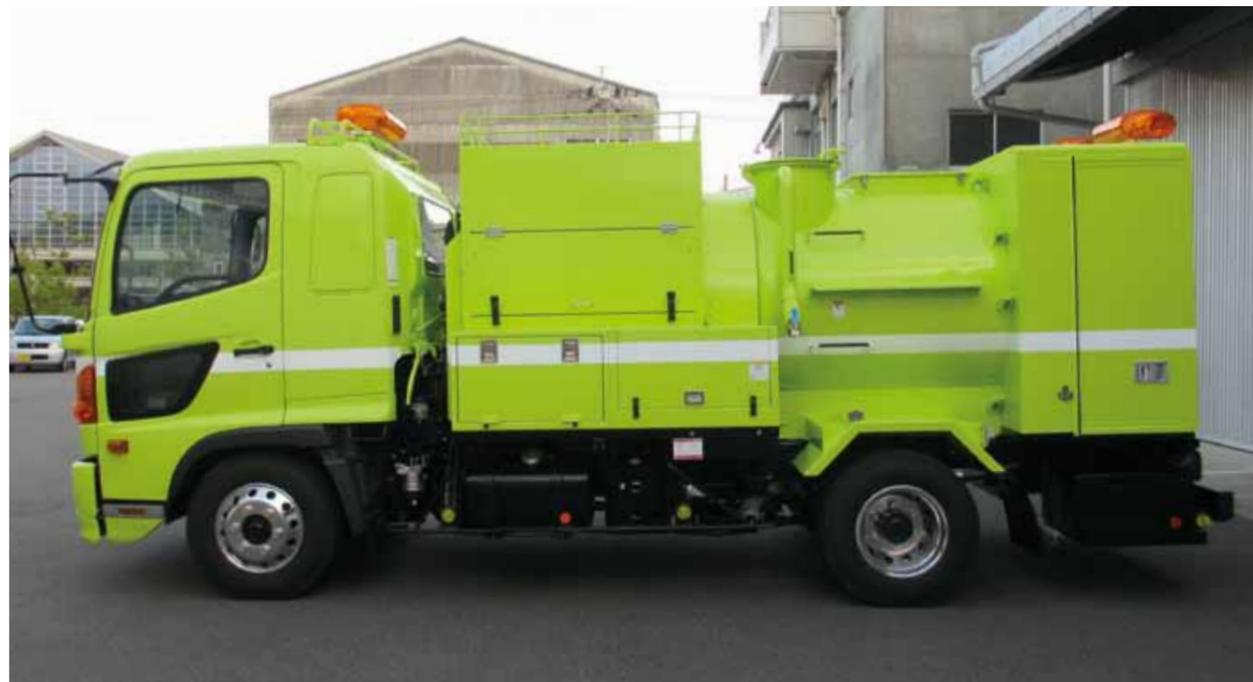
モバイルジェットの特徴である後方ガイド管を活かした寒冷地仕様高圧洗浄車です。様々な凍結対策をとった、寒さの厳しい地域でも安心して洗浄作業が出来る車両です。
