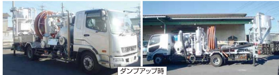
活性炭の抜き替え作業を行う為の活性炭専用吸引車です。吸引回収した活性炭は、フレコンバックへ袋詰めしトラックで運搬する為、本機単体では回収物の積載・運搬を行いません。吸引作業はレシーバータンクを立てた状態で行い、吸引物を下側に排出し、フレコンバックに袋詰めします。
