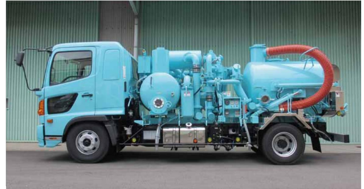
活性炭回収専用の吸引作業車として、狭い工場や施設内に入って行ける様、4トン車に50m<sup>3</sup>/minブローアを搭載した車輛です。
