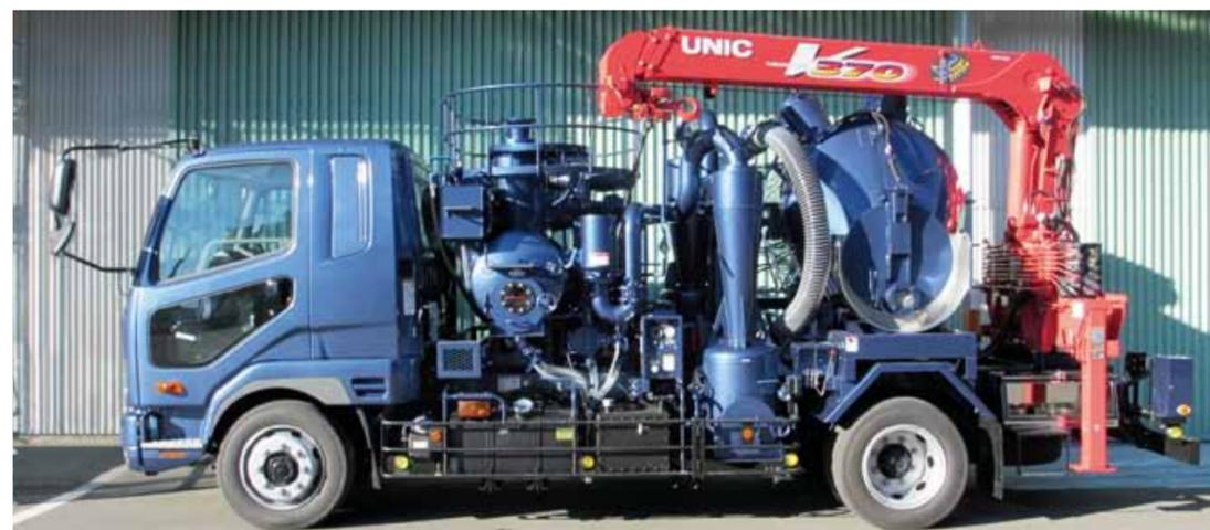
活性炭の抜き替え作業を行う為の、クレーン付き活性炭専用吸引車です。活性炭の吸引回収、フレコンバックへの袋詰めに加え、車載のクレーンでトラックへの積み込み、活性炭の再充填を行うことができます。また、回収タンクにリフトダンプ方式を採用しており、車の横にフレコンバックを置いて袋詰めすることが出来るため、作業時にスペースを取りません。
