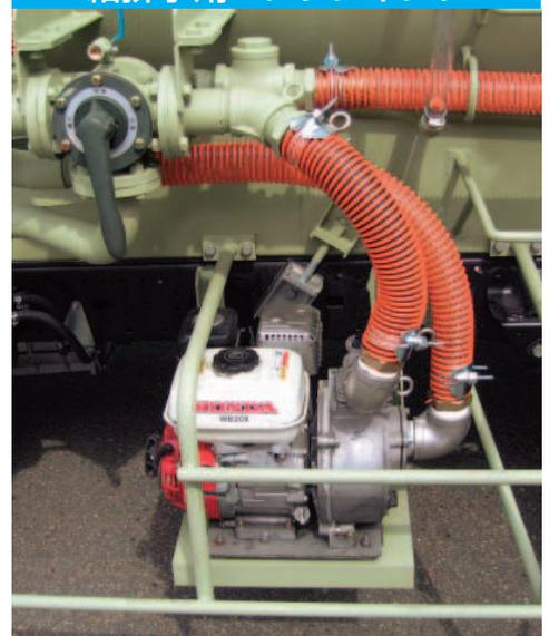
エンジンポンプにて、タンクへの給水及びタンクよりの圧力排水が出来ます。
