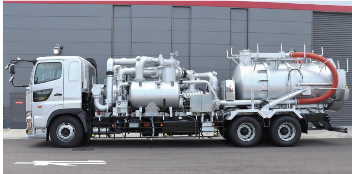
風量120m<sup>3</sup>/min、タンク容積7.0m<sup>3</sup>の超強力吸引作業車です。
