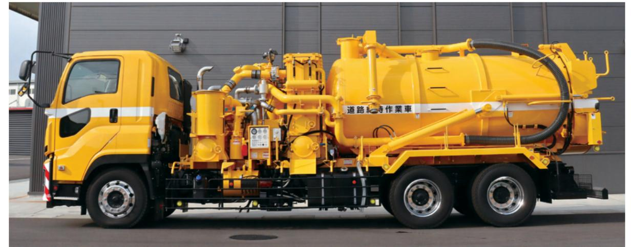
空冷式ブロワを搭載した乾湿切換吸引車です。粉体回収用として、ラメラフィルタを採用し、吸引力低下の抑制、メンテナンス性を向上しています。
