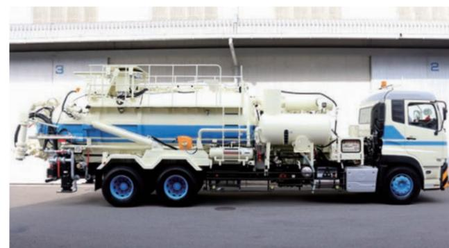
本車両は構内でのダスト等の回収後、受け入れ設備まで搬送し、圧送投入を行う専用車です。回収方式・圧送方式共に2方式を採用しており、状況に合わせて方式をお選びいただけます。
