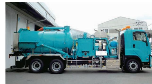
冷却水不要の空冷式ブロワを採用した「ネオモービルシリーズ」の大風量タイプです。
