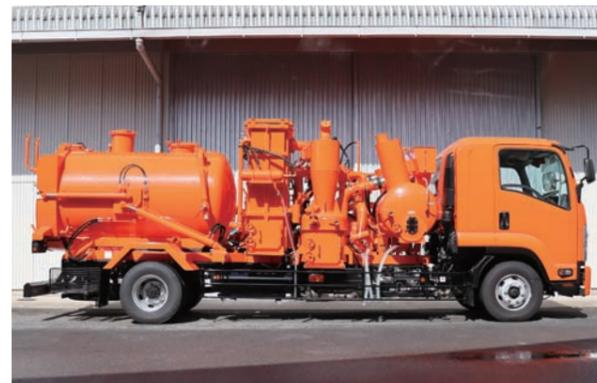
乾湿切换型のバグフィルター付き吸引作業車です。バルブの切り替え操作により、粉粒体・汚泥の両方を吸引可能です。
