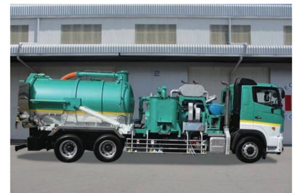
冷却水を使わない空冷式のブロワ搭載でご好評いただいております、ネオモービルの大風量タイプです。地下工事での高揚程吸引作業等、より強力な吸引力が求められる現場で活躍します。
