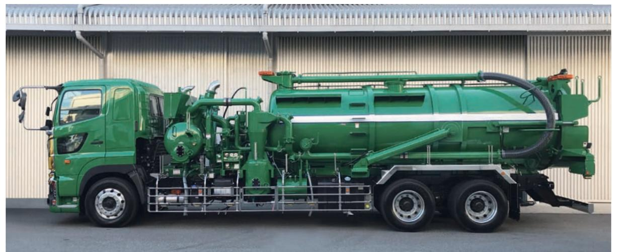
40m<sup>3</sup>/minシリーズでは最大級を誇るタンク容量をもつ強力吸引作業車です。タンク容量12m<sup>3</sup>、最大積載量10,390kgであり、一度に大量の吸引物を運搬できます。
