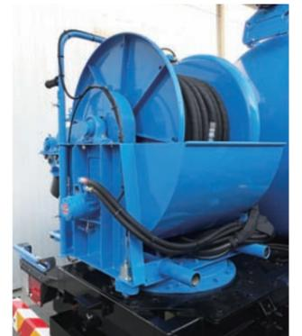
高圧・超高圧の2段切換ポンプを搭載した高圧洗浄車です。
