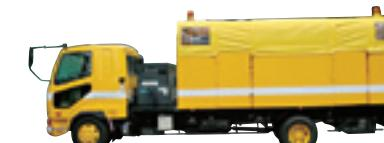
トンネル洗浄水処理車 (SP-04DB)
