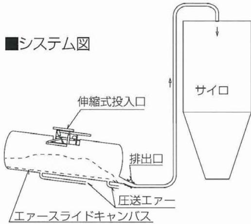
製鉄所構内での製銑ダストや製鋼ダスト専用の運搬・圧送車であり、ダストの受入れは車両上部の伸縮式投入口を設備に密着して行う為、発塵は皆無でしかも安全対策を考慮した機種です。
